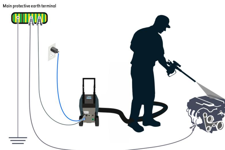
1. Pripojte IC-030 na hlavnú uzemňovaciu svorku budovy cez uzemňovaciu sadu na stroji.
