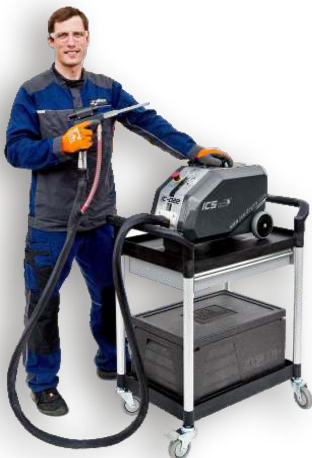
Die Reinigungswirkung von Trockeneispellets besteht in der Schwächung der Bindung zwischen der Verunreinigung und der Oberfläche durch die Auslösung eines Wärmeschocks. Der Vorteil des Trockeneisstrahlens ist die Eliminierung der Bildung des sekundären Abfalls und von Lösungsmitteln ohne die Notwendigkeit der Stilllegung und Unterbrechung der Kontinuität des Produktionsprozesses.
